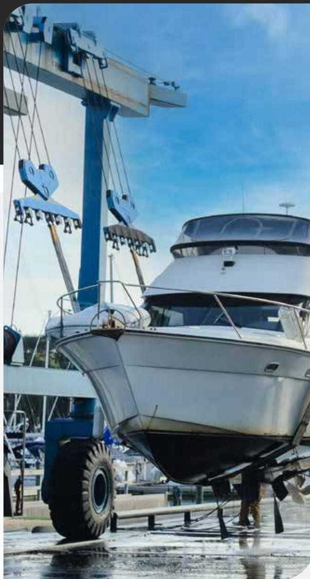
Particolarmente rilevante è il concetto di **"Travel Lift"**, il quale identifica queste macchine e rappresenta un passo avanti nel campo della movimentazione navale. Questi dispositivi sono dotati di un avanzato sistema di sterzata a ruote indipendenti, gestite da un sistema elettronico di controllo. Ciò consente all'operatore, tramite un radiocomando o un pannello di controllo a bordo, di selezionare la soluzione di sterzata più appropriata a seconda delle condizioni circostanti.
